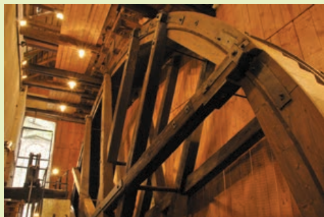
Kamšt – leseno vodno pogonsko kolo s premerom 13,6 m je eden najpomembnejših tehniških spomenikov v Sloveniji in največja ohranjena tovrstna naprava v svetu.
